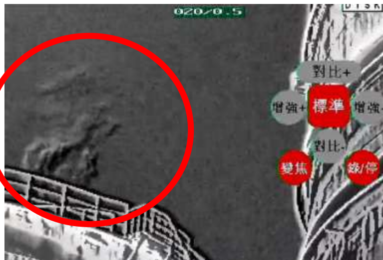
储罐呼吸阀泄漏情况
