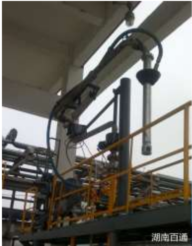
气动马达驱动汽车密闭装载
