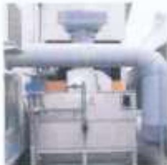
循环吸附方式（化学试剂） サイクロン吸着方式（薬液）
