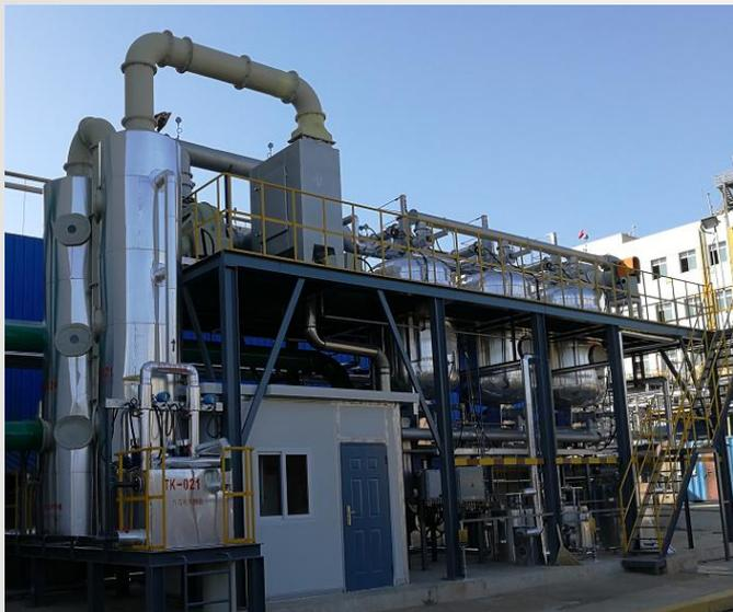
住化凯飞大孔树脂吸附冷凝回收装置
