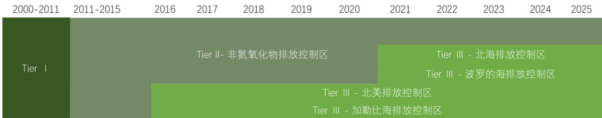
图 5.20 IMO 远洋船舶氮氧化物排放控制历程
