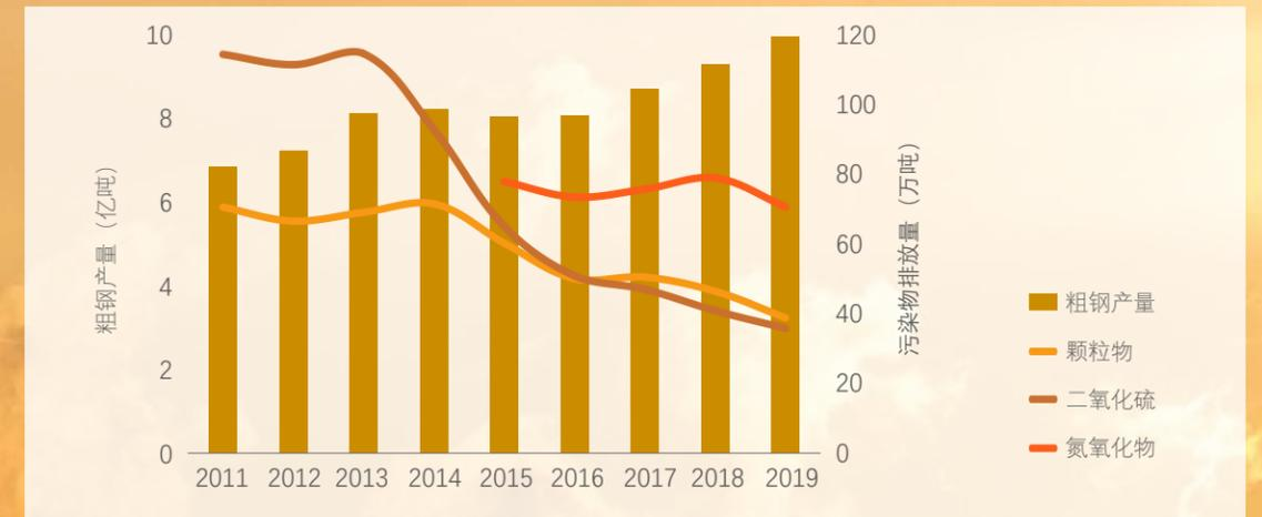
图 6.1 2011-2019 年中国粗钢产量和钢铁行业大气污染物排放量
